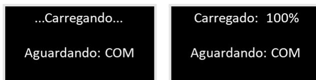
Figura 9 - Tela inicial de transferência de dados e recarga da bateria.
