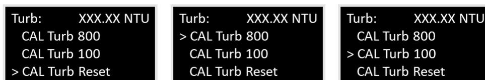
Figura 15 - Sequência de calibração do sensor de Turbidez.
