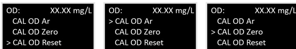
Figura 13 - Sequência de calibração do sensor de Oxigênio Dissolvido.
